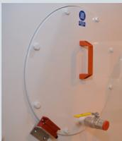
Trampilla de inspección para observación y mantenimiento básico.
